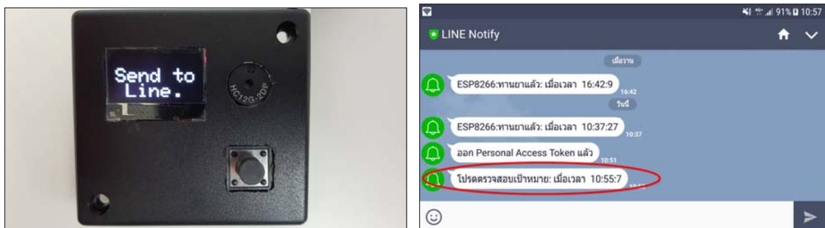
ภาพที่ 7 กรณีไม่มีการตอบสนองของเป้าหมายระบบจะแจ้งเตือนผ่านแอปพลิเคชัน Line
